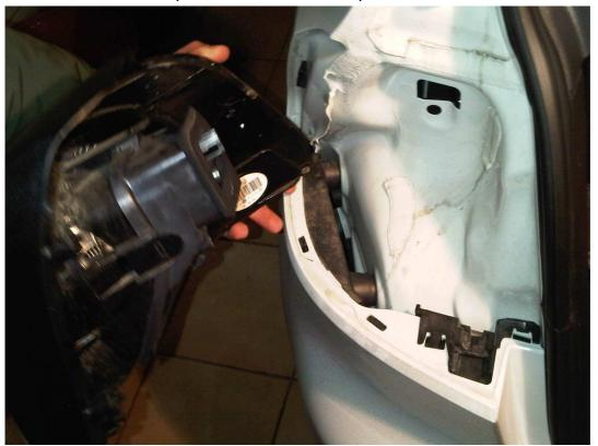
Non tirare con troppa energia, il faro è fissato alla carrozzeria anche mediante delle linguette di plastica sul faro. Se si rompono i fari non potrebbero essere fissati correttamente. Le ho cerchiate in rosso, spero si vedano bene
