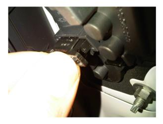
Una volta smontati i dadi e staccati i connettori, spingete il faro dalla lampade verso l'alto
