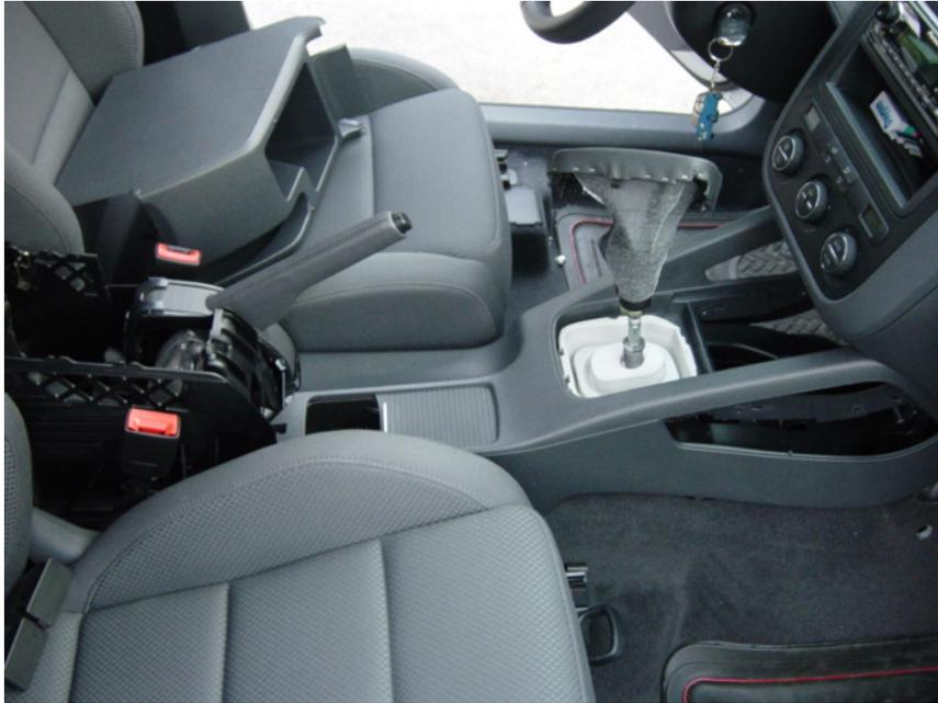
6) Infine, dopo aver montato il porta bicchieri ed aver saldato a caldo le bocchette, incastrare, inserendolo dall'alto la copertura posteriore del bracciolo ed infine in ordine inverso gli altri pezzi del tunnel.
