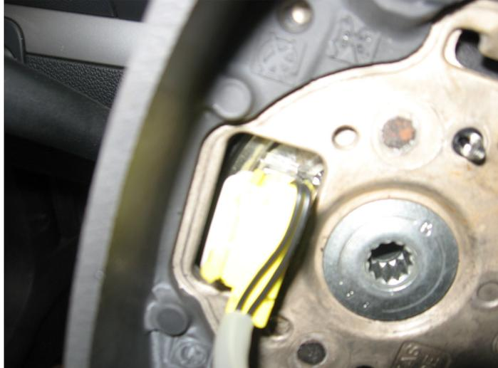
**Ora mettere il volante in posizione perfettamente diritta! E svitate la vite centrale, con una mille righe M12 (io l'ho fatto con una torx 55)**
